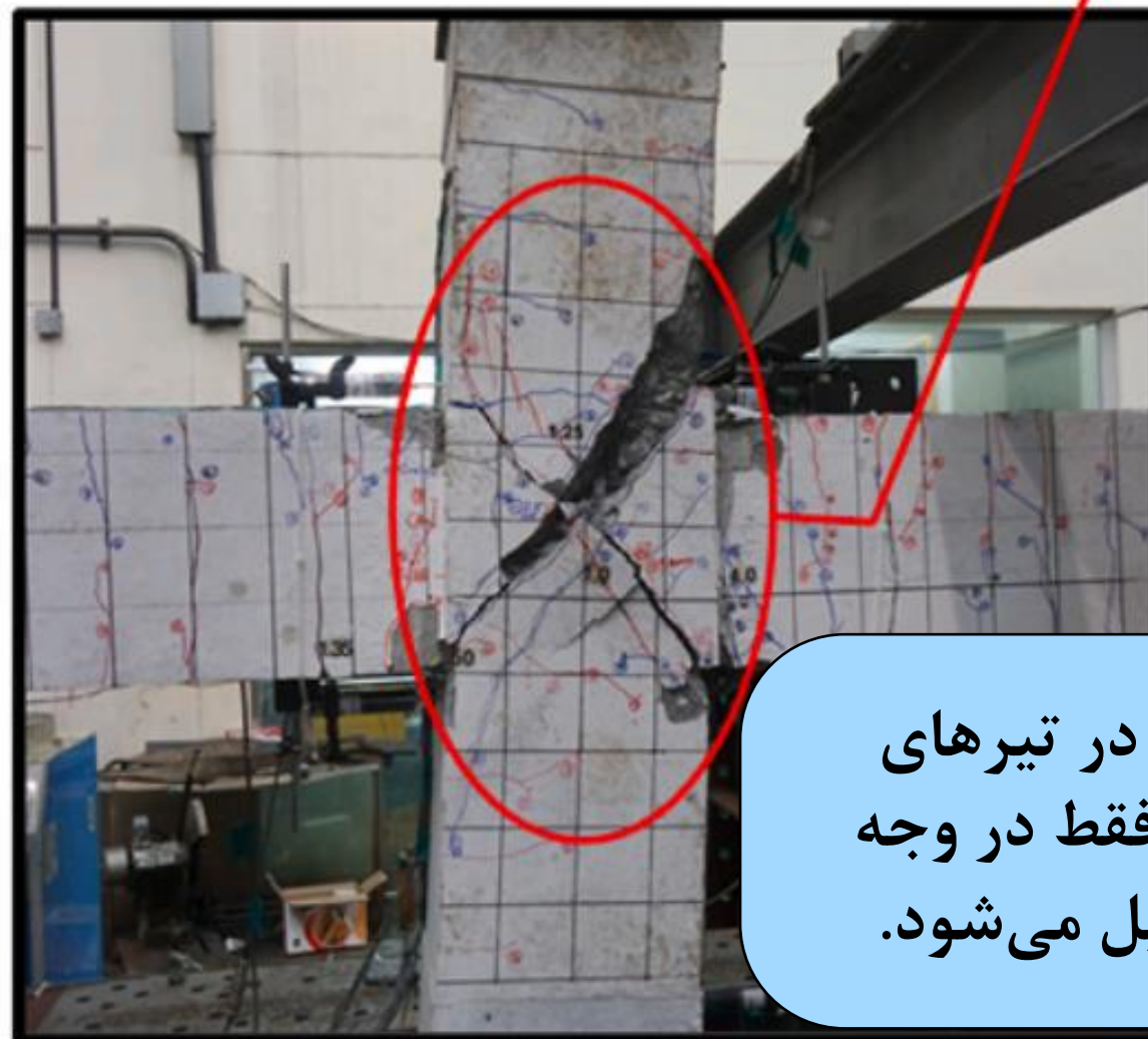
(d) drift ratio of 6.0% (ultimate state)
